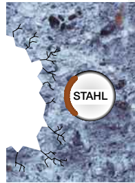
1. Vollständige Entfernung von abgeplatztem Beton.
